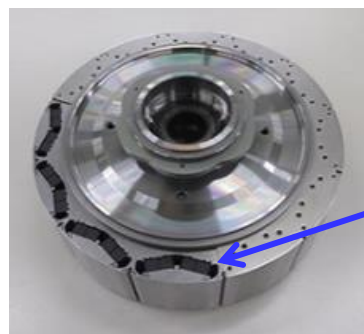
HEV駆動モーター用磁石：重希土類完全フリー磁石
