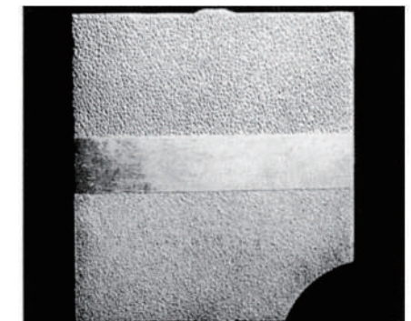
焊接后→时效处理 (500°C x 5hr、风冷)
